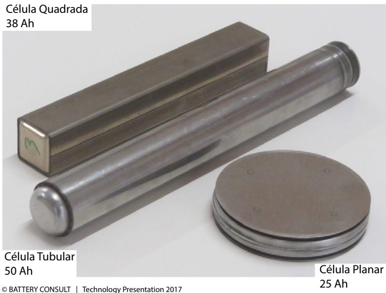
Figura 1. Exemplo de diferentes formatos das células eletroquímicas de Na/NiCl 2 (Imagem fornecida cordialmente pela Battery Consult AG ).
